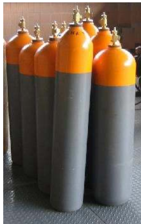
Cilindros de cloro no modo correto de em que devem ser armazenados
